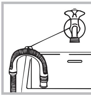
Sprinjiniți-l de marginile căzii sau chiuvelei și racordați șina de ghidare din dotare la robinet (a se vedea figura). Capătul liber al furtunului de golire nu trebuie să rămână cufundat în apă.
